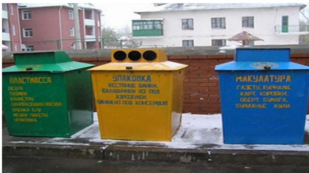
Рис. 4.17 Контейнер К-0,75 с крышкой, доработанный для отдельного сбора ОТХОДОВ
