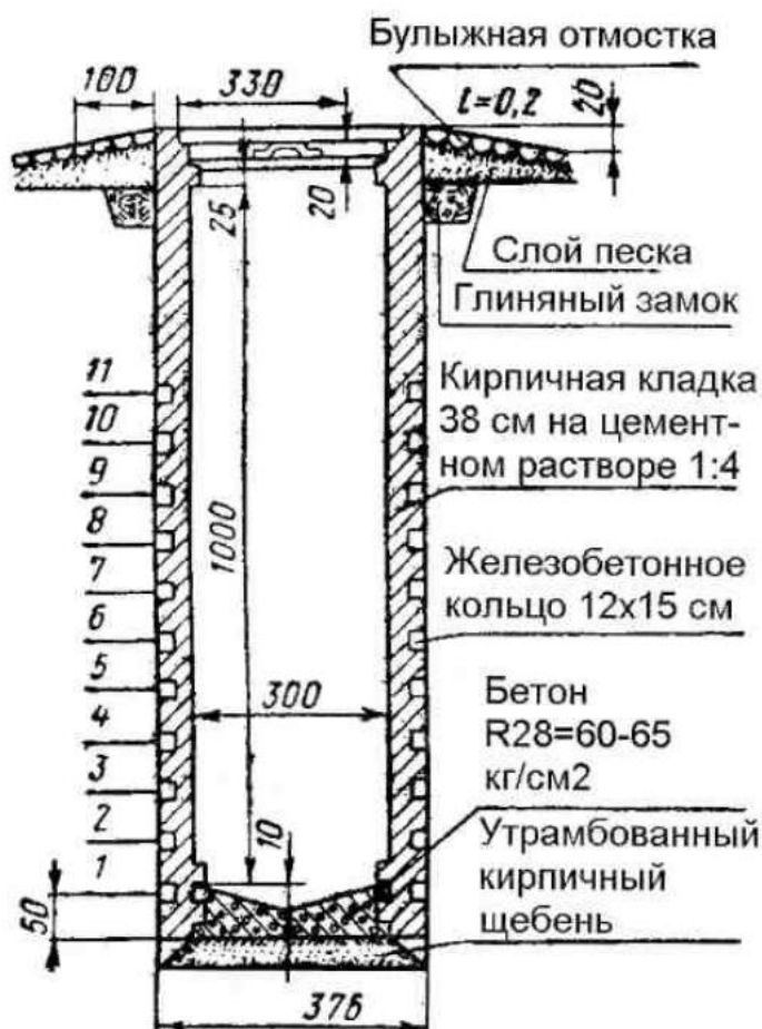
Рисунок 4.12.3 – Биотермическая Яма для уничтожения трупов животных На территории скотомогильника (биотермической ямы) запрещается:
